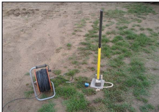
Sistema di energizzazione: geofono trigger, mazza e piastra di battuta.
