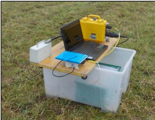
Sistema di acquisizione GEODE e interfaccia pc.
