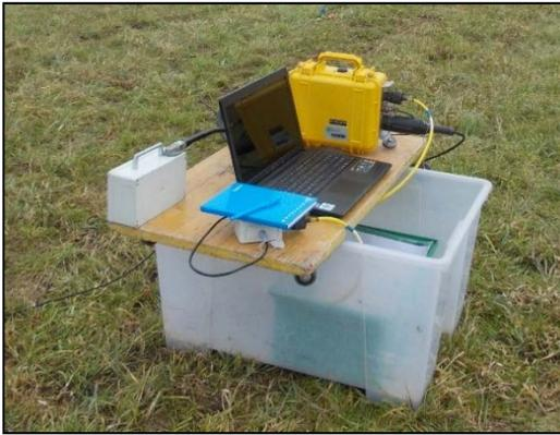
Sistema di acquisizione GEODE e interfaccia pc.
